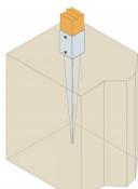
Les pieds de poteau carrés à enfoncer PPJET sont préconisés dans la réalisation de petits ouvrages tels que les clôtures de jardin. Très faciles à démonter, ils sont particulièrement adaptés pour des structures temporaires.
