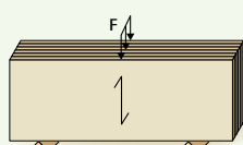
B f_{m,90,edge} et E_{90,edge} À chant, perp. au fil du bois ♦♦
